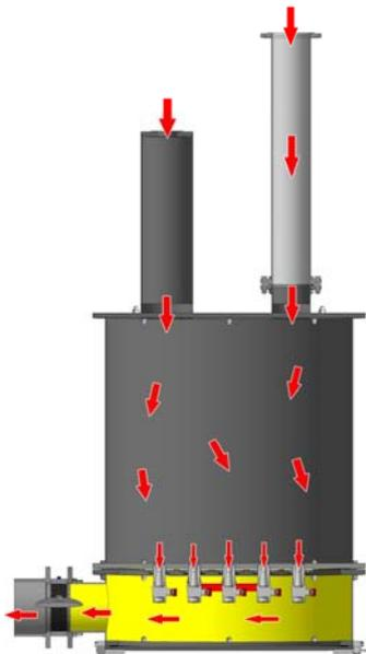
Необходимое значение расхода обеспечивается включением определенной комбинации ЭПР. В процессе поверки необходимо поддерживать критический перепад давления между ресивером и сопловым блоком. Включение и выключение ЭПР осуществляется при помощи шаровых кранов, установленных со стороны выходных сечений критических сопел. Доступ к шаровым кранам осуществляется через дверцу соплового блока, которая после выполнения необходимых опера-
