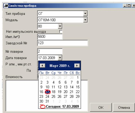
По показаниям барометра введите значения атмосферного давления. При вводе значения атмосферного давления в мм.рт.ст. оно автоматически пересчитывается в Па.
