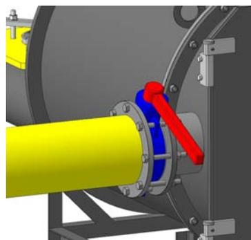
Используя фланцевые соединения с резиновыми уплотнительными кольцами, установите необходимые измерительные магистрали.
