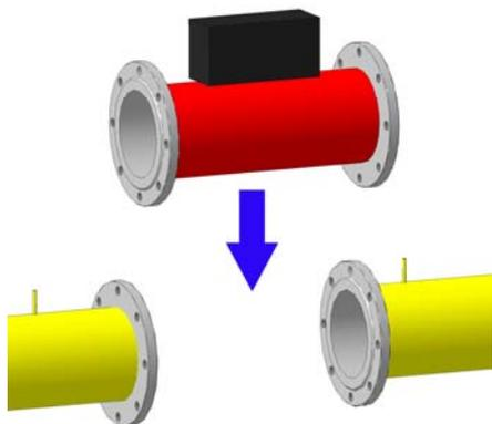
Снимите заглушку с входного канала используемой измерительной магистрали и установите ограничительную сетку.
