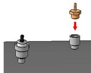
Установите на переходник свободный конец пневмотрассы, промаркированной «Разрезание в ресивере», и зафиксируйте его хомутом.
