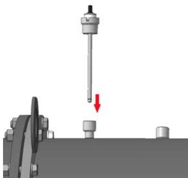
Датчик температуры следует вставить чувствительным элементом в штуцер, затем рукой закрутить за рельефную гайку.
