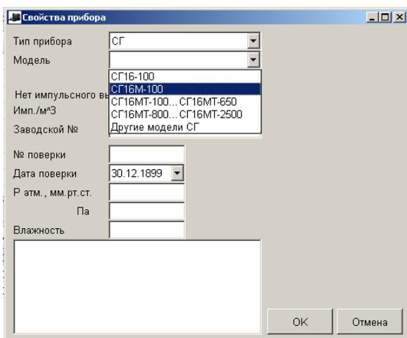
Если у поверяемого прибора нет импульсного (частотного) выхода, то необходимо в соответствующем окне поставить галочку, кликнув в нем левой кнопкой мыши. Наличие либо отсутствие импульсного выхода определяет режим проведения поверки. При наличии импульсного выхода поверку можно проводить в автоматизированном режиме, а при его отсутствии - только в ручном.
