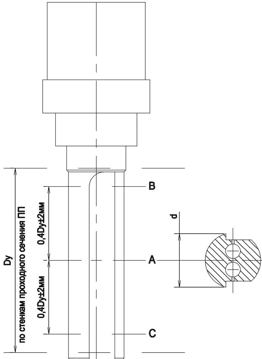
**Измерения проводить в 3-х сечениях ТО:**
