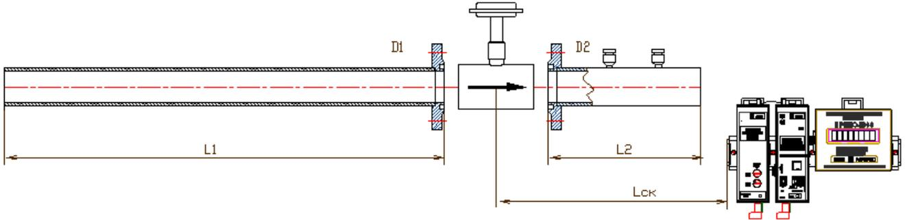
1. Измерение внутреннего диаметра трубопроводов узла учета.
