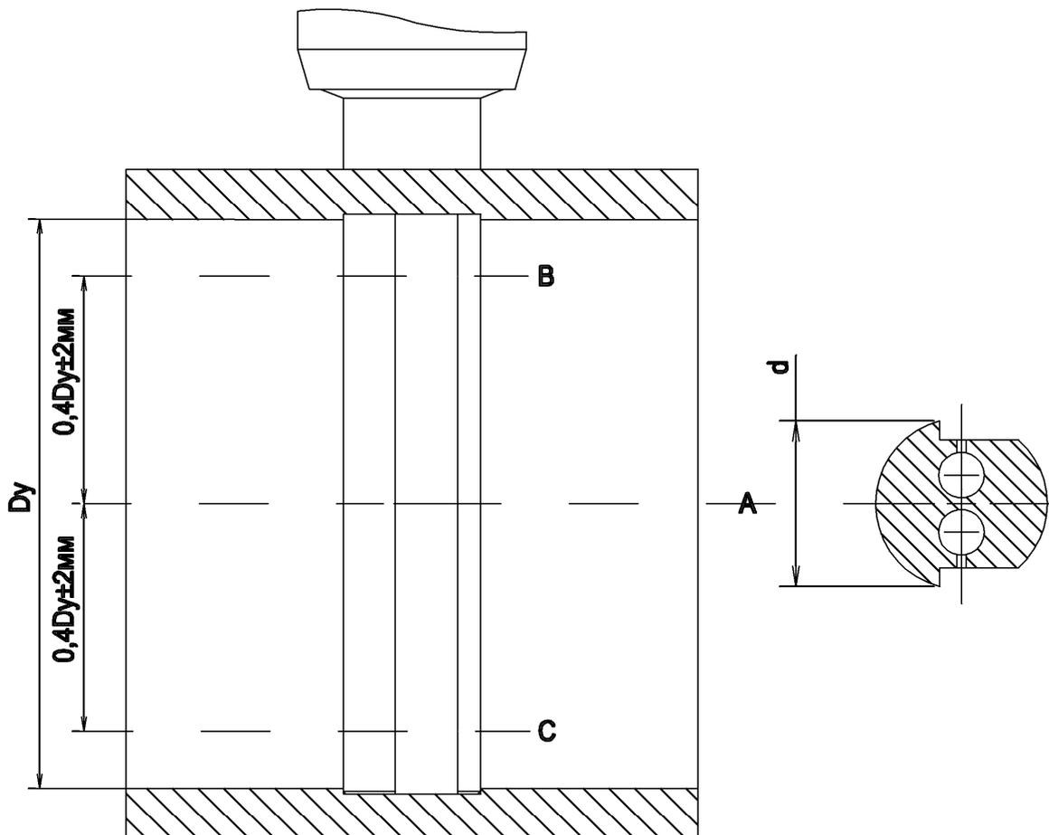
**Измерения проводить в 3-х сечениях ТО:**
