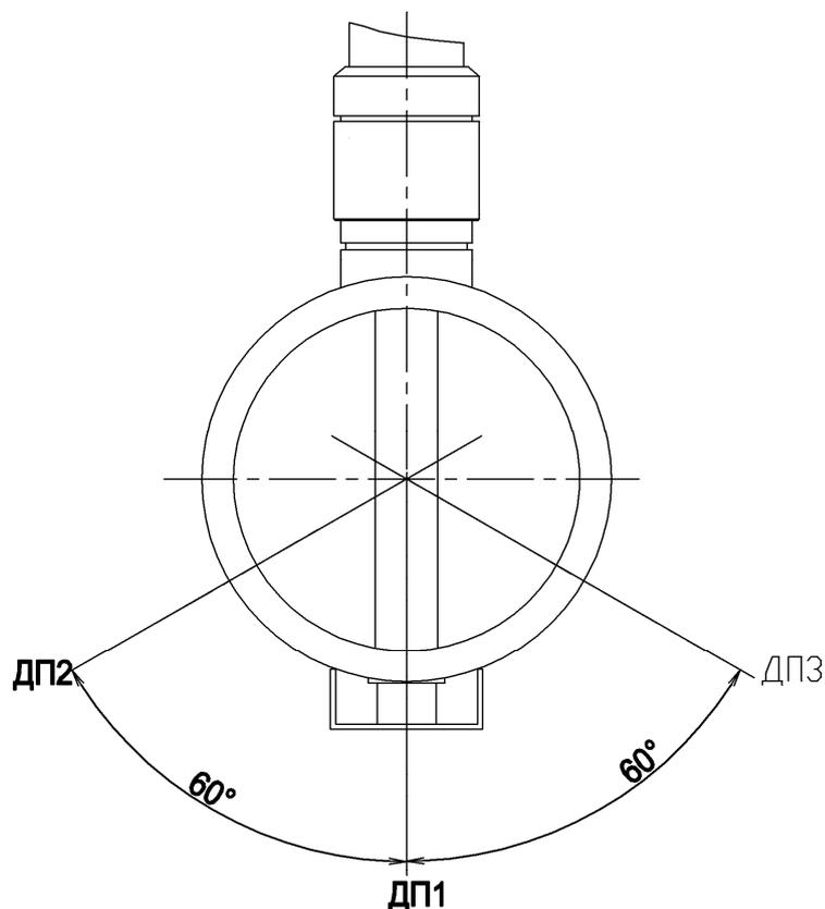
**Измерение диаметров входного и выходного сечения ПП проводить в диаметральных плоскостях ДП1...ДП3 на глубине 5...15 мм от торца ПП.**
