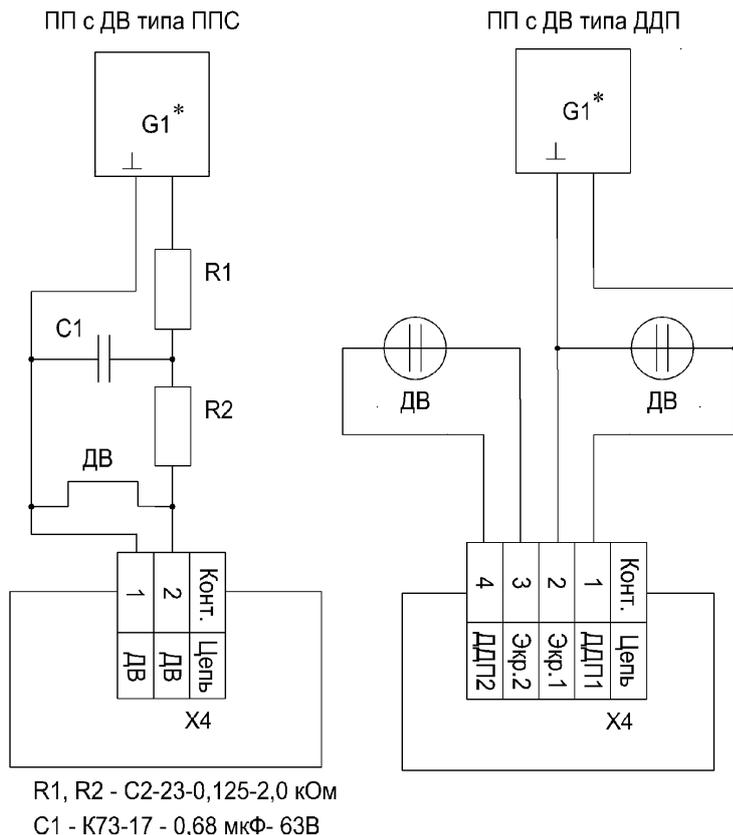
**Схема подключения генератора импульсов к БИП ИРВИС-К300**
