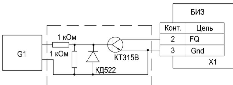
Рис. 3. Схема подключения генератора импульсов к ПП ИРВИС-К300
