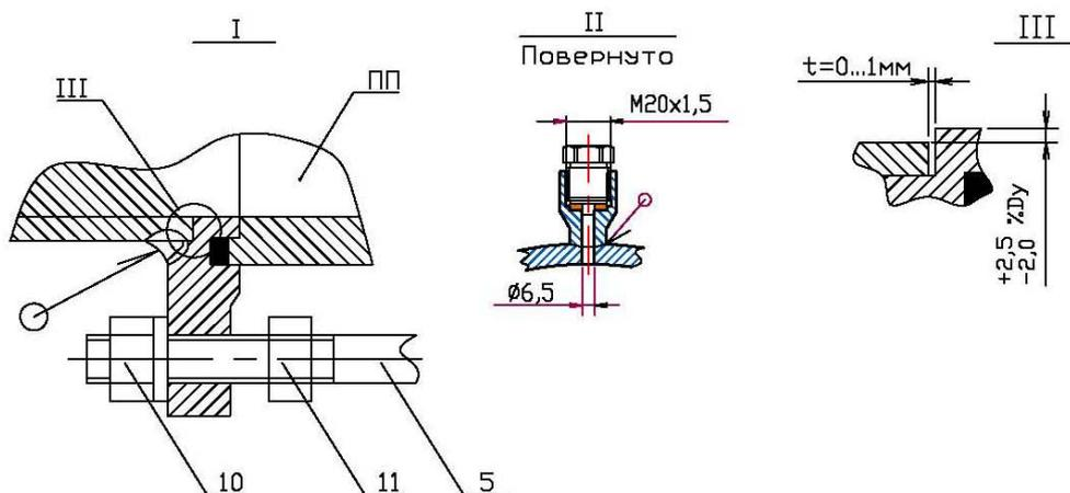
При установке/демонтаже ПП использовать шпильки с удлиненной резьбой из монтажного комплекта в соответствии с рисунком. При снятой гайке 9, свинчивая гайку 8 развести ответные фланцы до освобождения ПП.
