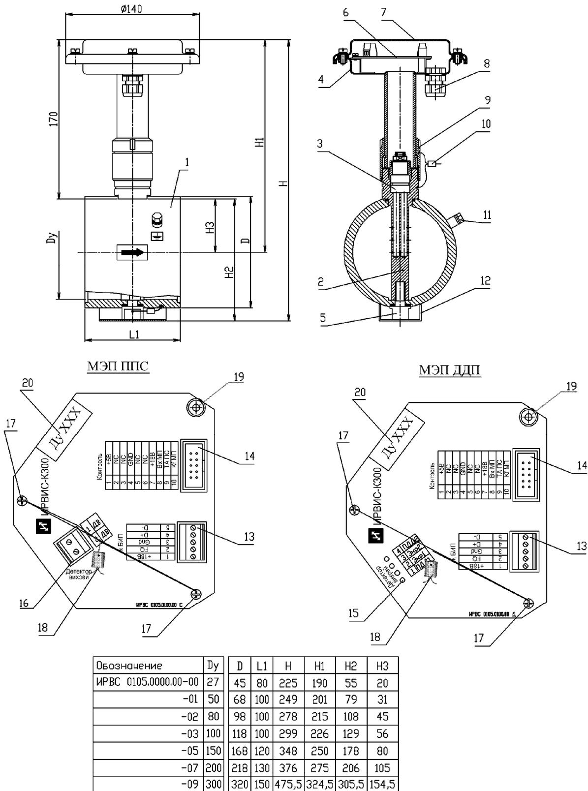
1. Корпус ПП; 2. Тело обтекания; 3. ДВ; 4. Корпус БПУ; 5. Спецболт; 6. МЭП; 7. Крышка БПУ; 8. Кабельный ввод; 9. Накладная гайка; 10. Пломба; 11. Винт заземления; 12. Опорная скоба; 13. Клеммные колодки для подключения СК; 14. Контрольный разъем; 15. Контакты для подключения ДВ типа ДДП; 16. Клеммные колодки ДВ типа ППС; 17. Пломбиривочный винт; 18. Пломба, 19. Пломбиривочная чашка, 20. Маркировка МЭП по Ду.
