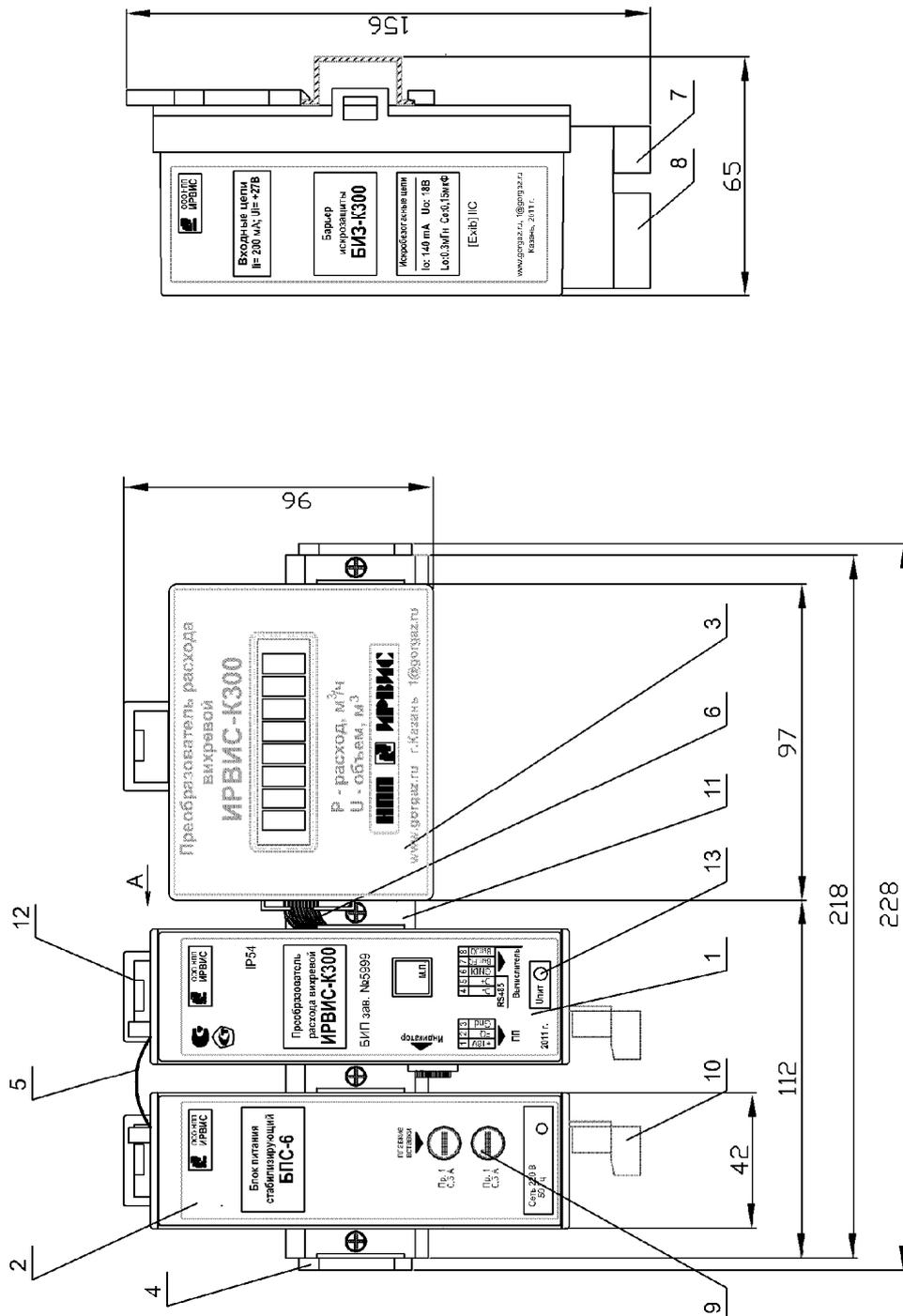
1. БИЗ; 2. БПС; 3. БИ; 4. DIN-рейка; 5. КК; 6. Шлейф БИ; 7. Контактная система для подключения интерфейсного кабеля; 8. Контактная система для подключения SK; 9. Плавкие предохранители сети; 10. Контактная система для подключения сетевого кабеля; 11. Ограничитель; 12. Щелчка; 13. Индикатор питания ПП.
