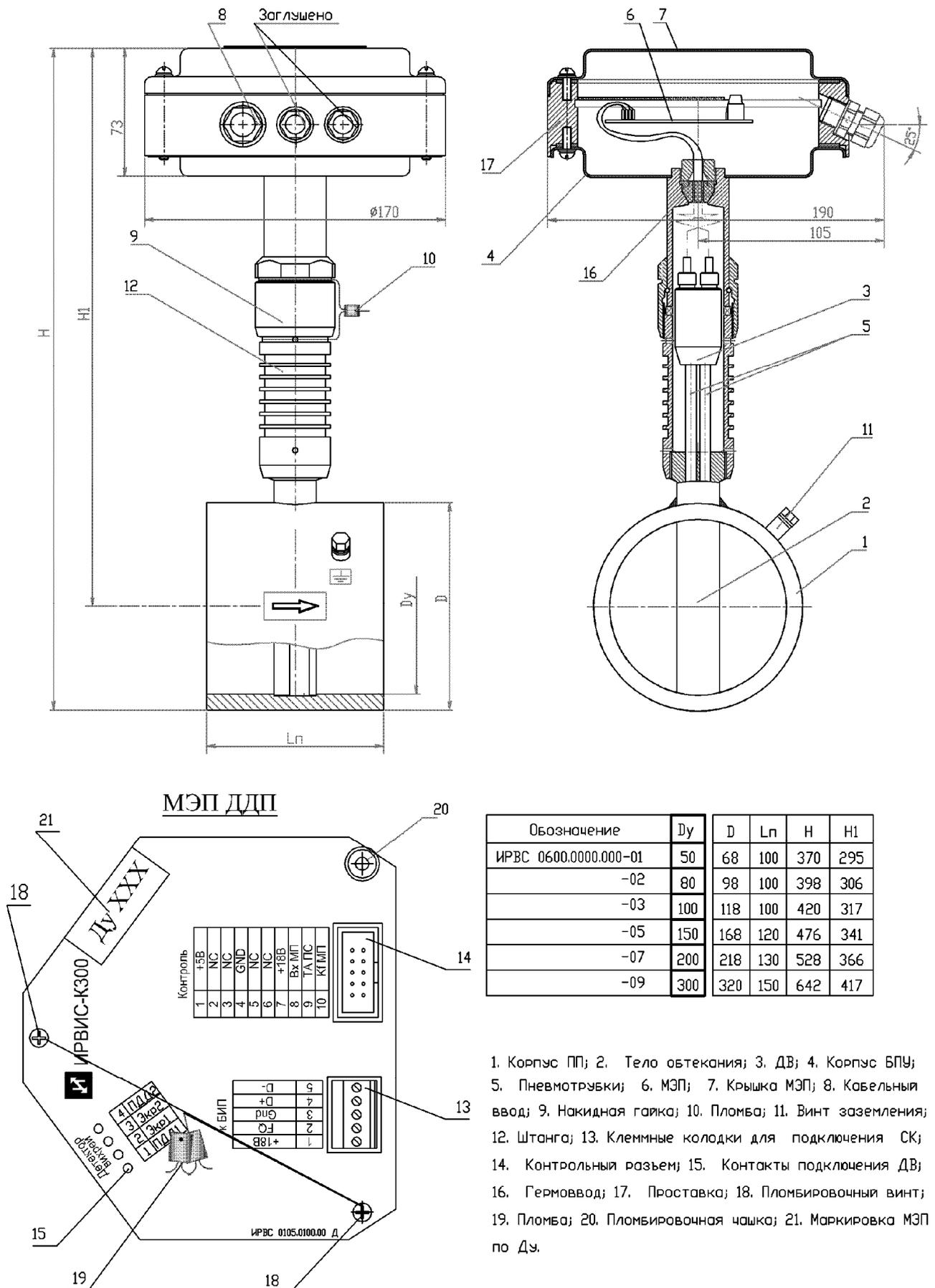
1. Корпус ПП; 2. Тело обтекания; 3. ДВ; 4. Корпус БПУ; 5. Пневматрубки; 6. МЭП; 7. Крышка МЭП; 8. Кабельный ввод; 9. Накладная гайка; 10. Пломба; 11. Винт заземления; 12. Штанга; 13. Клемные колодки для подключения СК; 14. Контрольный разъем; 15. Контакты подключения ДВ; 16. Гермоввод; 17. Проставка; 18. Пломбирочный винт; 19. Пломба; 20. Пломбирочная чашка; 21. Маркировка МЭП по Ду.
