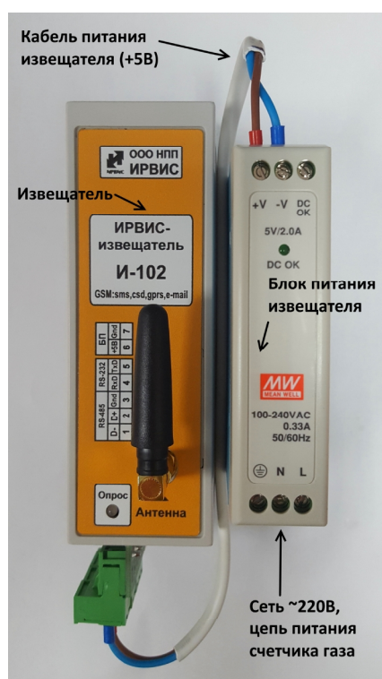
Подключение кабелей RS-485 и питания к извещателю
